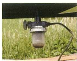
カップに亀裂と配管の折れ
