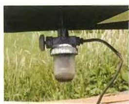
カップに亀裂と配管の折れ
